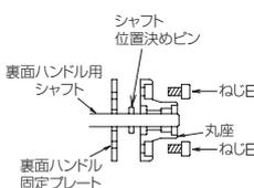
※丸座取付後はねじEにねじロックなどの適当な緩み止め処理を施してください。
