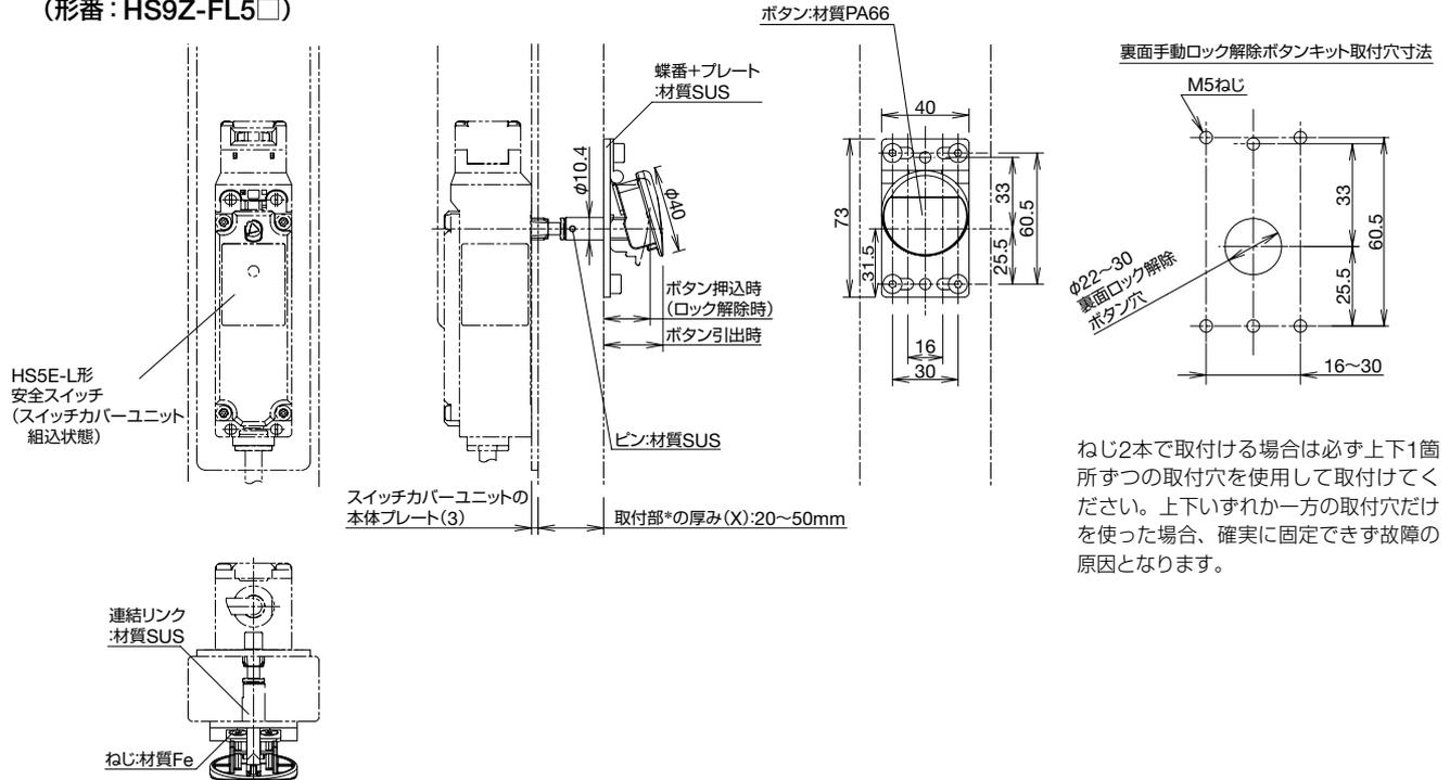
ねじ2本で取付ける場合は必ず上下1箇所ずつの取付穴を使用して取付けてください。上下いずれか一方の取付穴だけを使った場合、確実に固定できず故障の原因となります。
