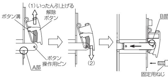
⑥ 固定用ねじにて固定後、解除ボタンを操作し、ロック/ロック解除が確実に実行されることをご確認ください。
